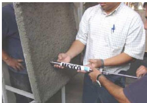
Figura 5-3 – Realização do ensaio com o penetrômetro de profundidade constante para determinação da evolução de resistência inicial.
