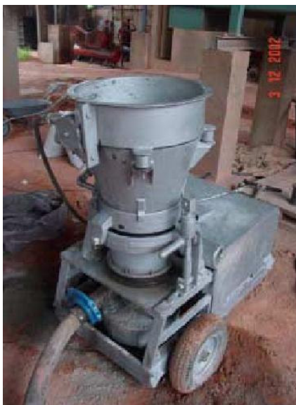
Figura 5-2 – Máquina de projeção via seca utilizada no procedimento experimental.
